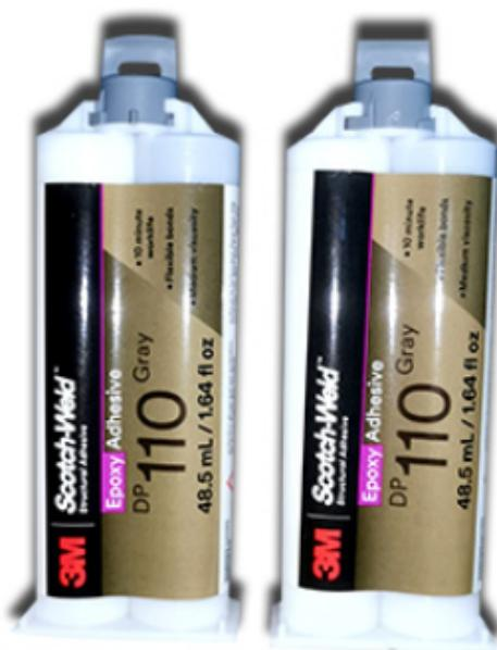
增韧环氧树脂：20世纪80年代，增韧环氧树脂问世。不像柔性环氧树脂那样，需要依赖低模量来提供抗冲击性和抗疲劳性，增韧环氧树脂在配制过程中采用较高的模量矩阵，其中加入了非常小的（微米级）橡胶颗粒。这些颗粒在承受压力时能吸收能量，并阻止微裂纹的扩展，从而提供\*\*\*的抗冲击和抗疲劳性能。增韧环氧树脂目前被运用于要求较高的应用当中，如移动基站的粘接、武器粘接、运动产品制造（复合山地自行车框架和高尔夫球杆头与杆体的粘接）等。增韧环氧树脂保留了此类胶黏剂所固有的环境耐受性能，通常是\*\*度焊接和机械紧固更换的比较好选择。重
